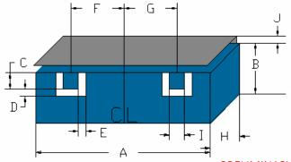
Nominal Tolerance Dim. (mm) (±mm or Max) 8.97 max В 2.00 est max С 0.89 0.13 D 0.40 0.13 Ε 0.40 0.13 F 2.70 0.13 G 2.70 0.13 Н 3.10 max 0.89 0.13 1.00 max
